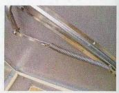
Inverser les plaques d'ancrage des ressorts permet à ceux-ci de travailler le plus en ligne possible
